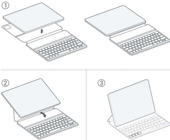
ملاحظة: لـ تدخل لوحة المفاتيح في وضع التشغيل إلا بعد ربط اللوحة ولوحة المفاتيح معاً بشكل صحيح كما هو موضح أعلاه.
