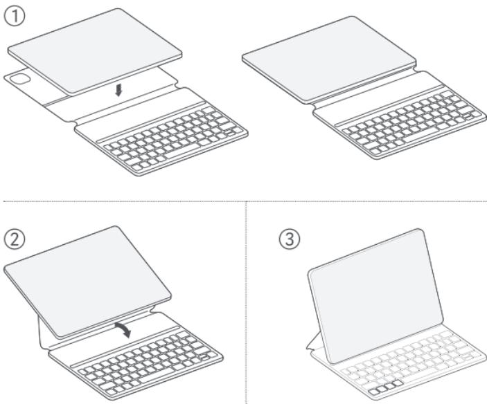
Nota: el teclado solo entrará en el modo de funcionamiento una vez que se hayan conectado la tableta y el teclado como se muestra arriba.
